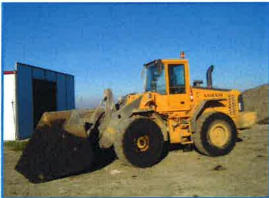
La Planta de Compostaje cuenta con dos palas cargadoras de ruedas, de potencia 225 CV. La marca de las mismas es Volvo L 120 E. Para la realización de los trabajos disponen de cazos que cubican 4,5 m<sup>3</sup> además de tener instalado el sistema de alto volteo para favorecer entre otros aspectos la carga de camiones, la aireación del compost en los volteos y la realización de pilas de mayor altura.
